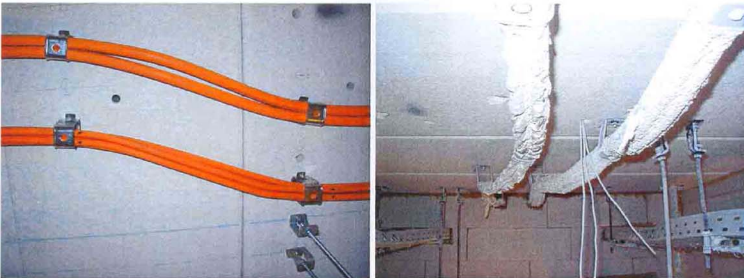
Bild A9.3 und A9.4: Versatz der Sammelhalterung vor und nach dem Versuch
