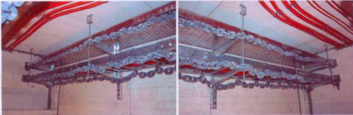
Bild A7.1 und A7.2: Abhängekonstruktion vor dem Versuch, Blick nach links und rechts
