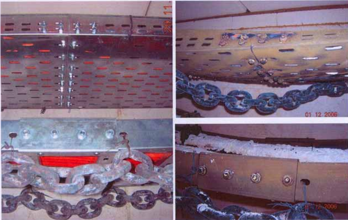
Bild A7.5 bis A7.7: Stoßstelle Leiter und Rinne 400 mm vor und nach dem Versuch
