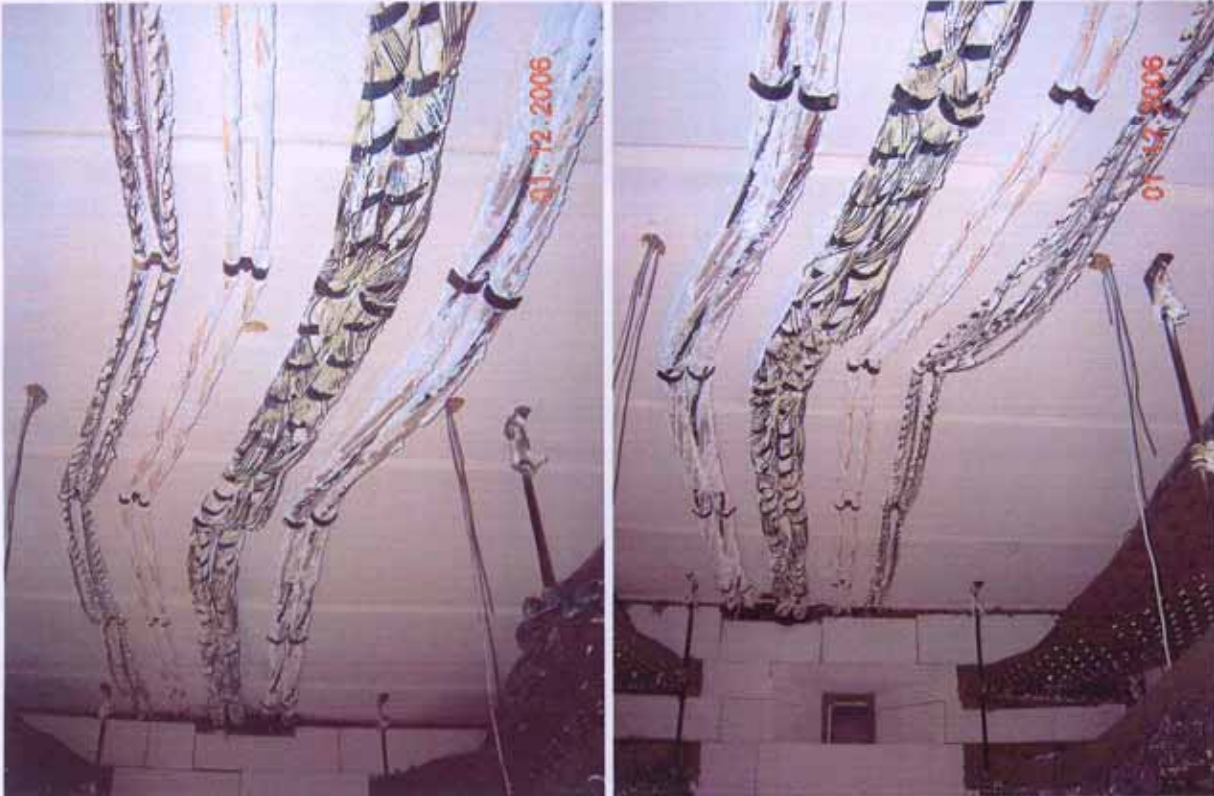
Bild A9.4 und A9.5: Deckenverlegung mit Kabelschellen, von linker und rechter Ofenwand aus gesehen nach dem Versuch
