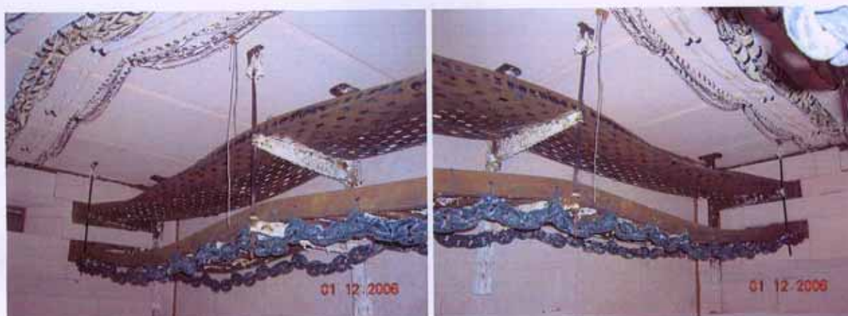
Bild A8.3 und A8.4: Abhängekonstruktionen nach dem Versuch, Blick nach links und rechts
