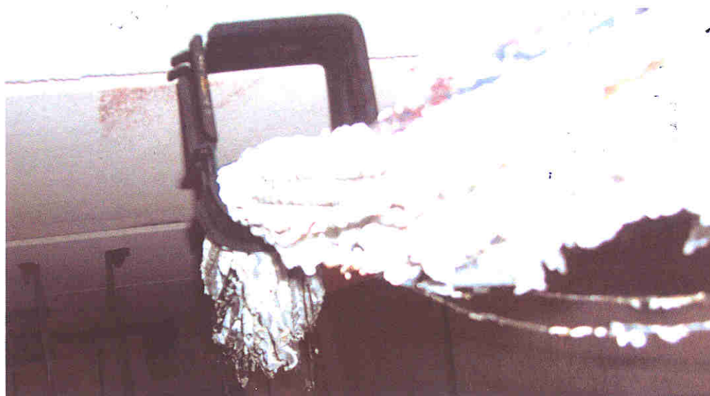
Bild A9.3 und A9.4: Deckenverlegung mit Sammelhalterungen nach dem Versuch
