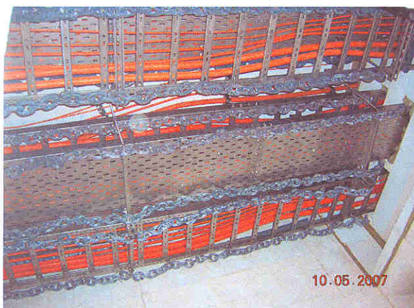
Bild A7.5 und A7.6: Doppelseitige Abhängekonstruktion, vor und nach dem Versuch, Rechts
