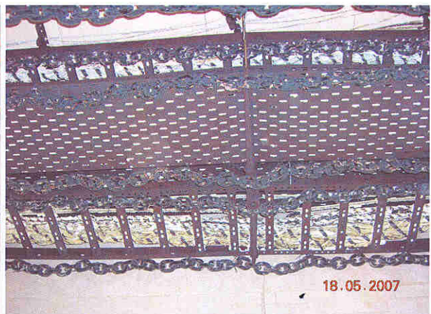
Bild A7.3 und A7.4: Doppelseitige Abhängekonstruktion vor und nach dem Versuch, Mitte
