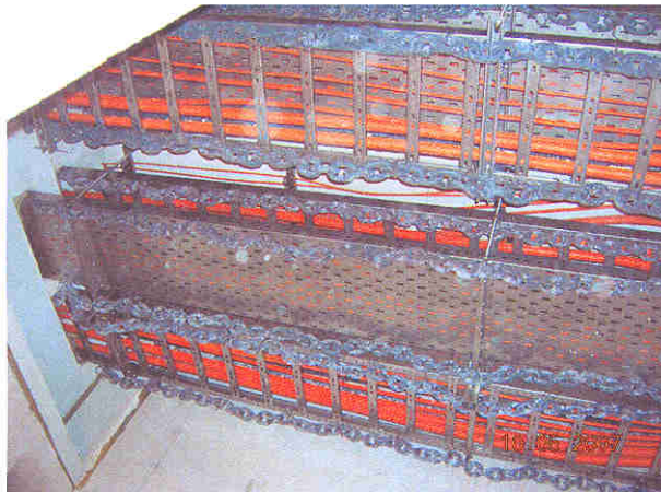
Bild A7.1 und A7.2: Doppelseitige Abhängekonstruktion vor und nach dem Versuch, Links
