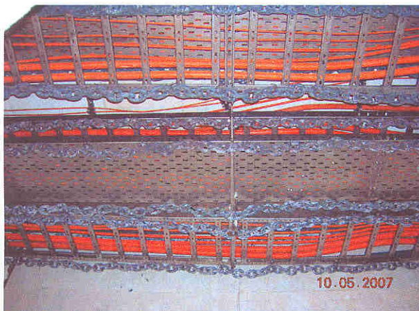
Bild A7.3 und A7.4: Doppelseitige Abhängekonstruktion vor und nach dem Versuch, Mitte
