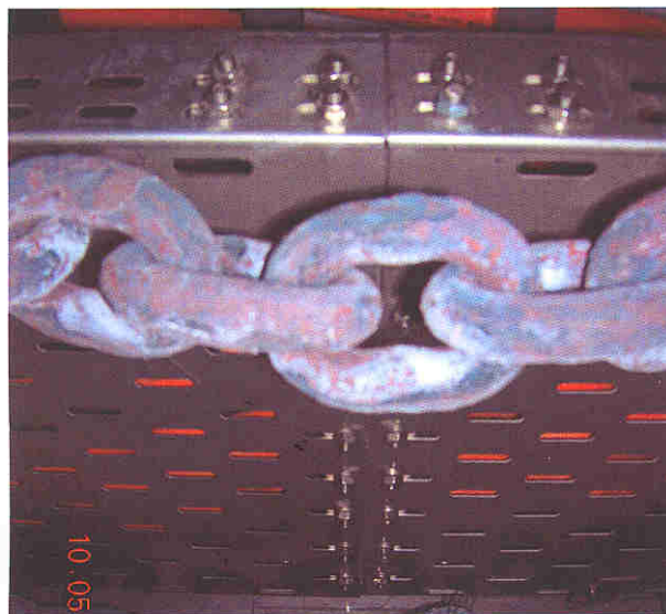
Bild A7.9 und A7.10: Stoßstelle Rinne 400 mm vor und nach dem Versuch
