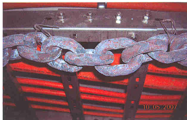
Bild A7.11 und A7.12: Stoßstelle Leiter 400 mm vor und nach dem Versuch
