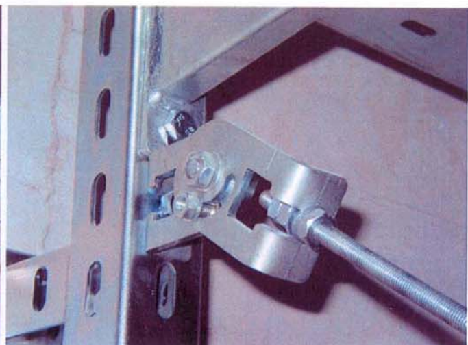
Bild A7.15: Stoß der Rinne nach dem Versuch Bild A7.16: Detail Gelenkanschluss
