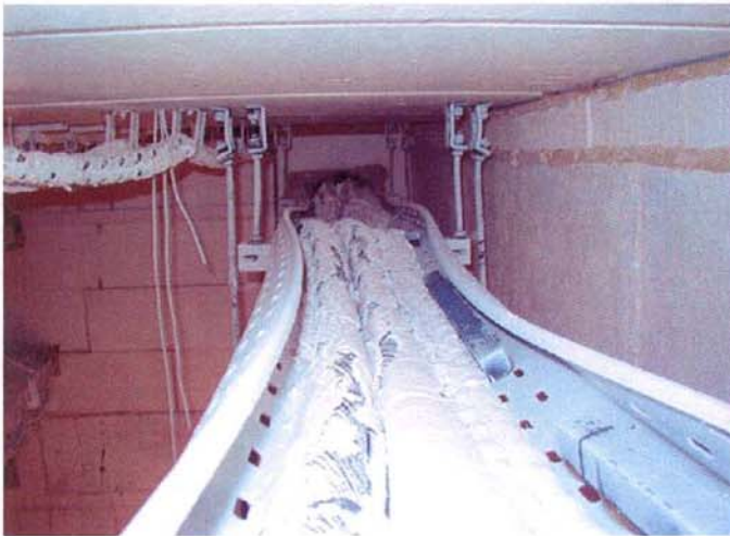
Bild A8.8 und A8.9: Blick auf die obere Kabelrinne und die mittlere Leiter nach dem Versuch
