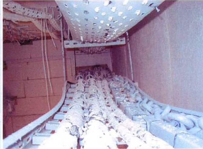
Bild A8.8 und A8.9: Blick auf die obere Kabelrinne und die mittlere Leiter nach dem Versuch
