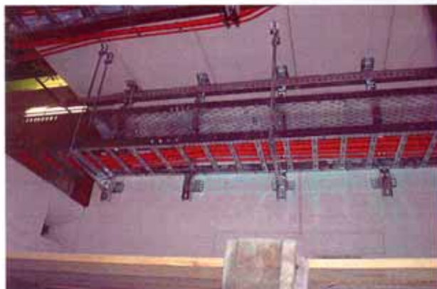
Bild A7.1 und A7.2: Wandauslegerverlegung vor dem Versuch, Blick nach links und rechts
