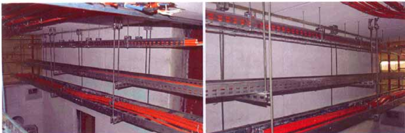
Bild A8.1 und A8.2: Abhängekonstruktionen vor dem Versuch, Blick von links und rechts
