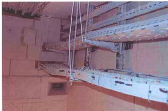
Bild A7.11 und A7.12: Wandausleger und Sammelhalter mit Rinne an der Wand nach dem Versuch, Blick nach links und rechts, geringe Durchbiegungen
