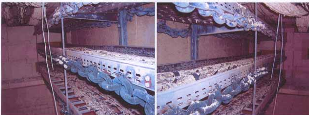
Bild A7.3 und A7.4: Wandauslegerverlegung nach dem Versuch, Blick nach links und rechts
