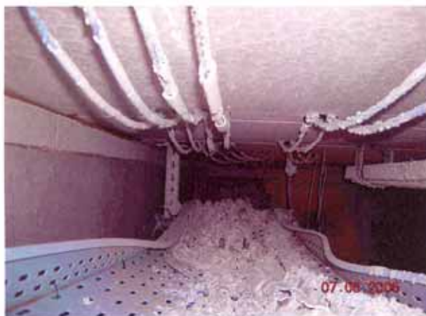
Bild A9.5: Deckenverlegung mit Kabelschellen, Fernmeldekabel nach dem Versuch
