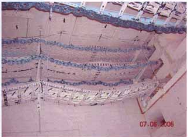
Bild A7.9 und A7.10: Detail Mittelabhängung und Feld rechts nach dem Versuch, geringe Durchbiegungen
