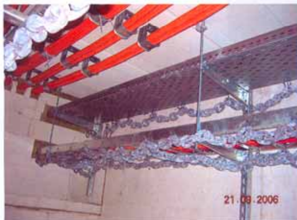
Bild A7.1 und A7.2: Abhängekonstruktion vor dem Versuch, Blick nach links und rechts
