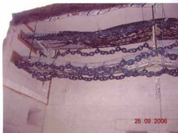
Bild A7.3 und A7.4: Wandauslegerverlegung nach dem Versuch, Blick nach links und rechts
