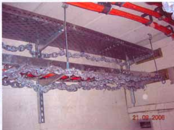
Bild A7.1 und A7.2: Abhängekonstruktion vor dem Versuch, Blick nach links und rechts
